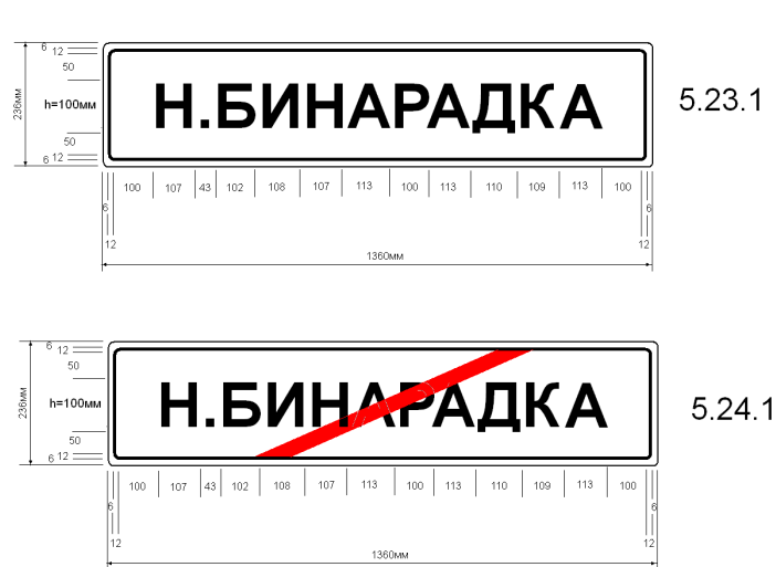
Эскиз дорожного знака 5.23.1 и 5.24.1 с расчетом размеров, исходя из требований ГОСТа Р 52290-2004г.
